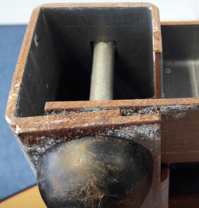
Corrosie aan snijranden van een voorgecoat staalproduct.
