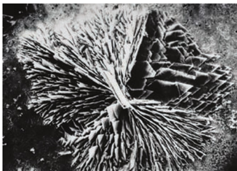
Cristaux de \text{CaHZn} après 24 h dans une solution de \text{Ca}(\text{OH})_2 de pH 12,6
