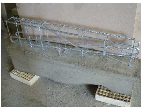
Mensole in cemento armato realizzate con acciaio zincato a caldo per i balconi di un elegante appartamento a Genova. L'armatura in acciaio zincato è stata scelta per preservare al meglio le mensole nel tempo, in particolare per proteggerle da smog, piogge, gelo e umidità. (Immagini gentilmente concesse dall'azienda Prefabbricati Torti di Pietro e Lino Torti snc)
