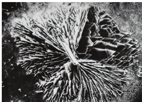
Cristalli di \text{CaH}_2\text{Zn} dopo 24h in una soluzione di \text{Ca}(\text{OH})_2 , a pH 12,6
