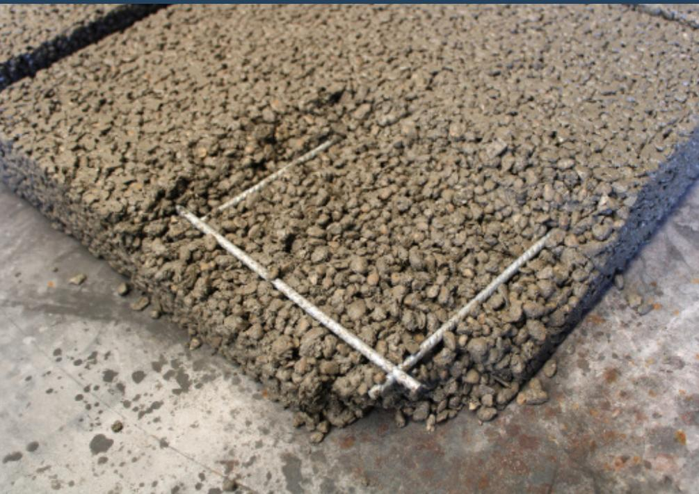
La zincatura a caldo dell'armatura in acciaio all'interno delle strutture in cemento può fornire una serie di vantaggi. In condizioni meteo estreme, è possibile fare a meno di aumentare lo spessore del copriferro. Quando sono richiesti componenti in cemento più leggeri e sottili, l'armatura in acciaio, grazie alla zincatura, sarà protetta dalla carbonatazione in caso di riduzione dello spessore del copriferro.
