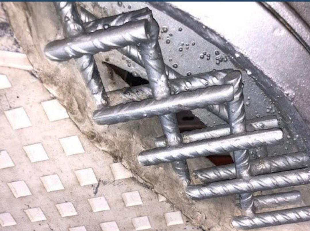
La zincatura a caldo dell'armatura in acciaio all'interno delle strutture in cemento può fornire una serie di vantaggi. In condizioni meteo estreme, è possibile fare a meno di aumentare lo spessore del copriferro. Quando sono richiesti componenti in cemento più leggeri e sottili, l'armatura in acciaio, grazie alla zincatura, sarà protetta dalla carbonatazione in caso di riduzione dello spessore del copriferro.
